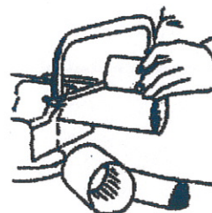
Fig.1 Raccourcissement de l'arbre d'entraînement de la prise de force
