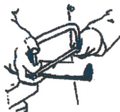
Fig.1 Raccourcissement de l'arbre d'entraînement de la prise de force
